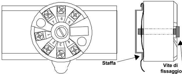
**Montaggio in testa per sonda DIN B**
