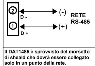
Il DAT1485 è sprovvisto del morsetto di shield che dovrà essere collegato solo in un punto della rete.
