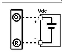
(\*) : Nota: per installazioni UL il dispositivo deve essere alimentato da una unità di alimentazione con classificazione NEC classe 2 o SELV
