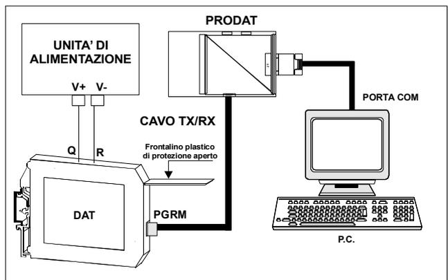
Attenzione: durante tutta la procedura il dispositivo deve essere sempre alimentato ed il cavo di collegamento non deve essere scollegato. Per informazioni dettagliate sul funzionamento del programma di configurazione, fare riferimento al relativo manuale operativo.
