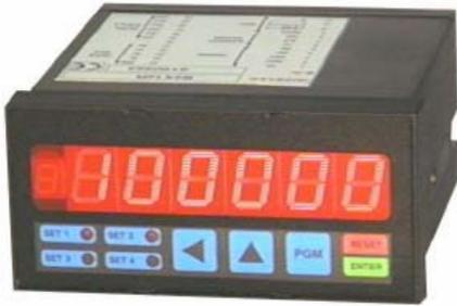
Contaimpulsori a 6 cifre; DIN 96x48 mm; singolo ingresso di conteggio; due contatori 6 cifre: parziale / totale; visualizzatore unico di uno dei due contatori; possibilità di richiamare l'altro contatore (attraverso la pressione del tasto ▲); due set (uno per contatore); conteggio sia monodirezionale; peso impulso settabile.
