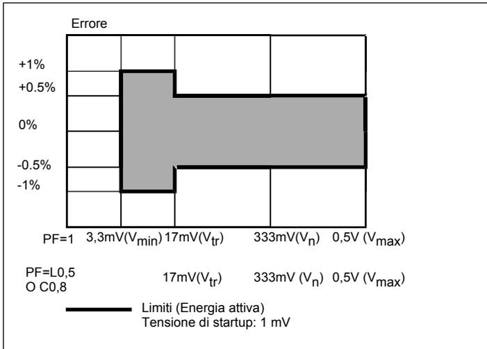
**VARh**, precisione in funzione del carico (TA con uscita in tensione)
