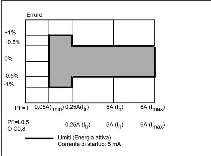
**VARh**, precisione in funzione del carico (TA con uscita in corrente)
