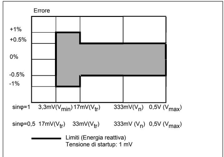
**Nota:** La precisione della potenza reattiva è garantita qualora lo strumento sia impostato per calcolo di Q tramite formula di Budeanu.
