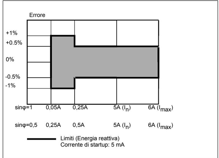
**Wh**, precisione in funzione del carico (TA con uscita in tensione)
