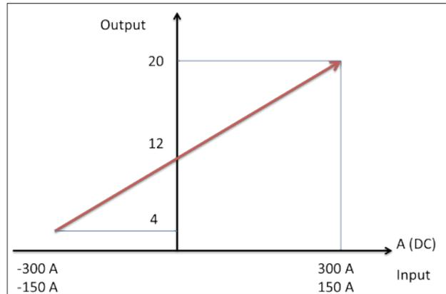
Il QI-300-I presenta due dip-switch attraverso i quali potete impostare il fondo scala a 150 o 300 A e selezionare la funzione monopolare o bipolare (vedi grafici), il led giallo posto vicino alla morsettiera vi indica la presenza dell'alimentazione. L'utilizzo della funzione bipolare è legata alla misura di correnti continue (la misura in AC darebbe un valore medio pari a 0 A ovvero 12 mA).
