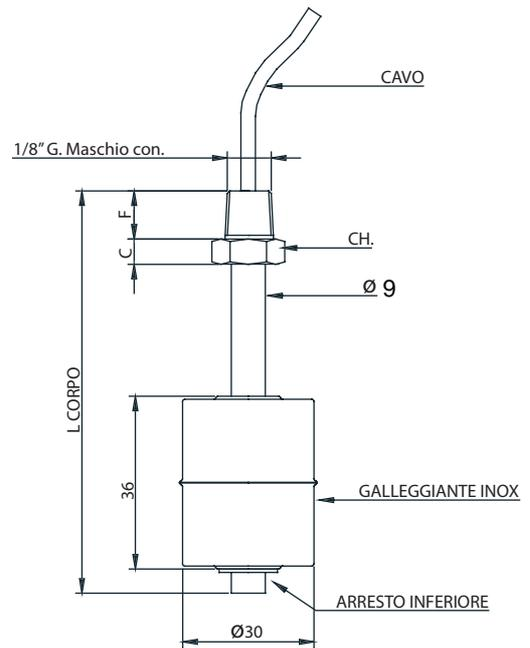
**UTILIZZO:** Costruiti interamente in Inox AISI 316, sono adatti nei processi produttivi di industrie chimiche, farmaceutiche ed alimentari. Adatti per solventi, diluenti e tutti i liquidi compatibili con l'Inox AISI 316.
