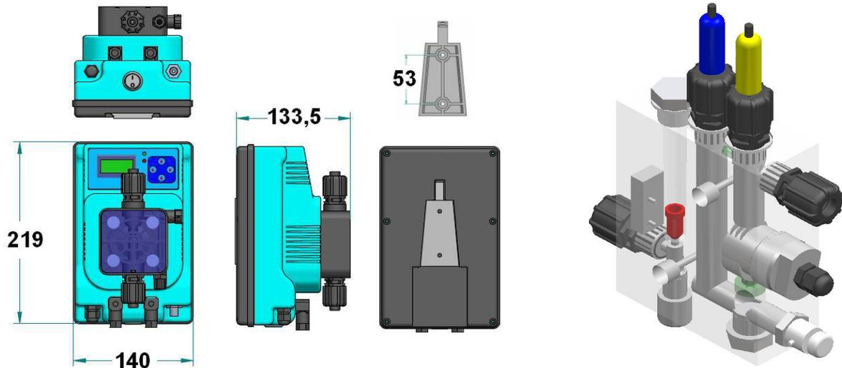
Scala di misura 0-5 mg/l; corpo plexiglass, sensore di flusso, elettrodo rame/platino
