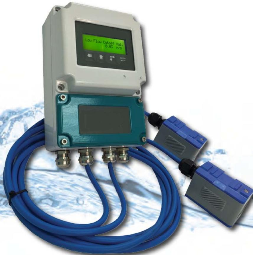
I misuratori 101F funzionano secondo il principio della differenza del tempo di transito di impulsi ultrasonori. Il grande vantaggio è nell'installazione, non essendo necessario tagliare la tubazione. I sensori vanno semplicemente fasciati sulla superficie esterna del tubo, ragione per cui pressione e aggressività del liquido da misurare non sono un problema. Il sistema misura in modo bidirezionale ed è idoneo per liquidi puliti o moderatamente sporchi.
