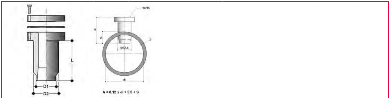
Raccordi a saldare in acciaio inox AISI 316L
