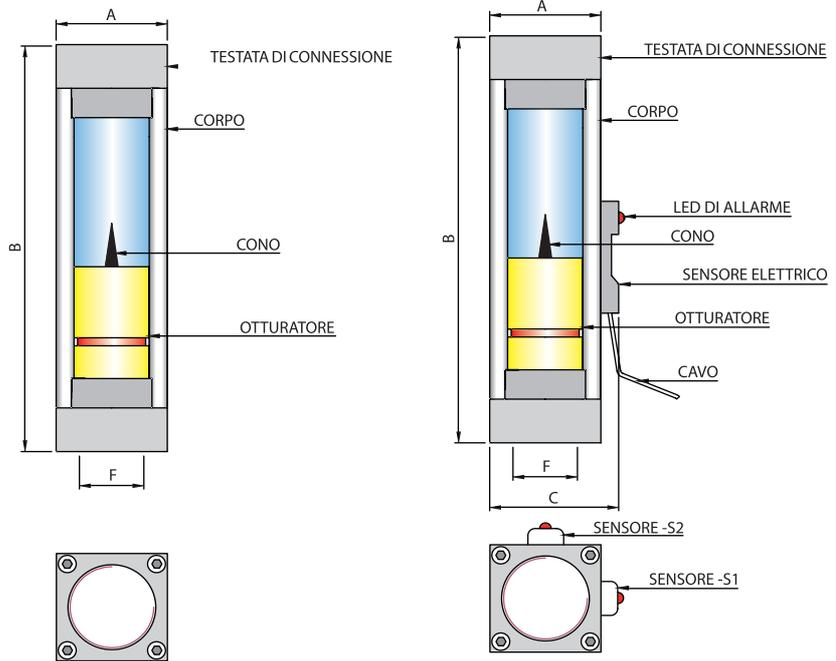
I **Flussimetri FLU/P** possiedono un'elevata visibilità su ogni lato ed una chiara lettura della scala.
