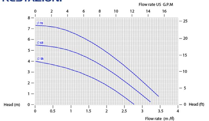
Le curve e le prestazioni si riferiscono a pompe con mandata libera con acqua a 20 °C, e motore a due poli 50 Hz. Questi dati possono variare in base ai materiali di costruzione e alle condizioni idrauliche.
