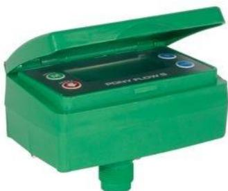
Il display grafico multilingua programmabile può indicare: volume cumulativo erogato (con azzeramento), volume cumulativo erogato (non azzerabile) e volume parziale in diverse unità di misura: litri, galloni per minuto, metri cubi/ora. Può essere applicato a tutti i modelli di contaltri a turbina da noi prodotti. Errore massimo di lettura: ±1%. Display retroilluminato. Alimentato a pila 9 Volt. Attrezzato con sensore di luminosità per aumentarne l'autonomia e il risparmio energetico
